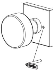
**⚠️** En cas d'urgence, insérez l'outil de déverrouillage d'urgence dans le trou de déverrouillage de la rossette extérieure pour ouvrir la serrure.
