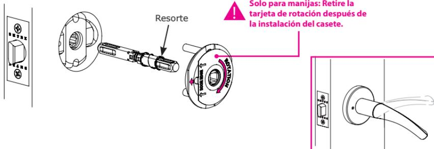
**Paso 5B:** Coloque el Cassette CF B con la flecha apuntando hacia el borde de la puerta. Fíjelo con (2) tornillos mecánicos. Verifique la alineación de la placa antes de apretar completamente los tornillos.
