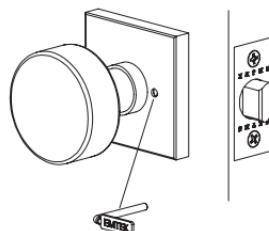
**En caso de emergencia, inserte la Herramienta de Liberación de Emergencia en el orificio de la roseta exterior para abrir la cerradura.**
