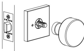
**Paso 6D:** Ajuste firmemente el tornillo de fijación preinstalado en la manija o la perilla, con la llave Allen suministrada. Asegúrese de que esté bien ajustado.
