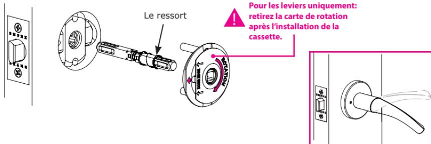
**Étape 5B:** Placez le CF cassette B avec la flèche pointant vers le bord de la porte. Fixez-le avec (2) vis de la machine. Vérifiez l'alignement de la garniture avant de serrer complètement les vis.
