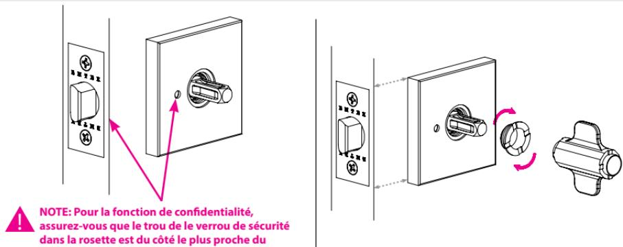
! NOTE: Pour la fonction de confidentialité, assurez-vous que le trou de le verrou de sécurité dans la rossette est du côté le plus proche du bord de la porte et s'aligne avec le trou dans le Cassette.
