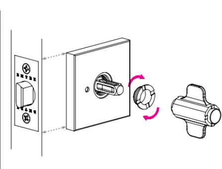
**! Para la función de privacidad, asegúrese de que el orificio del pasador de seguridad en la roseta esté en el lado más cercano al borde de la puerta y que esté alineado con el orificio del Casete.**
