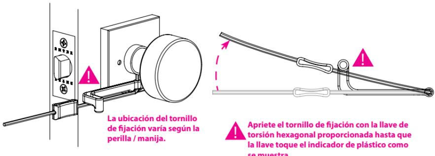
**Paso 6E: Repita pasos 6A-6D para el lado opuesto.** Para la función de privacidad atornille el pasador de seguridad a través de la roseta, en el pestillo. Para verificar la funcionalidad, gire la manija o la perilla para enganchar el pestillo. Ahora, empuje el pasador de seguridad y gire la manija o la perilla. La manija o perilla no debe retraer el pestillo.
