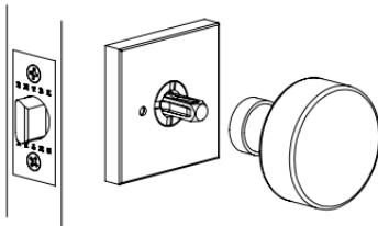
**Étape 6D:** Serrez fermement la vis de réglage pré-installée dans le levier ou le bouton à l'aide de la clé Allen fournie. Assurez-vous qu'il est fermement serré.
