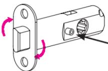
Si le loquet a une fonction de sécurité, le trou fileté de le verrou de sécurité doit faire face au côté intérieur de la porte.
