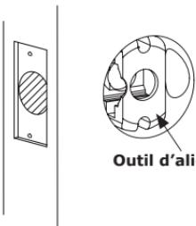
**Étape 2:** Insérez et fixez le pêne à l'aide des vis à bois n° 8 x 3/4 po.
