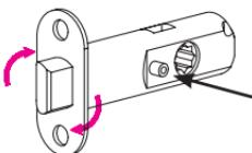
**Si el pestillo tiene una función de privacidad, el orificio roscado del pasador de seguridad debe estar orientado hacia el lado interior de la puerta.**
